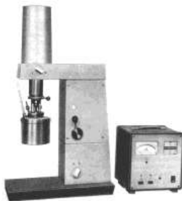
Vľavo: Rotačný viskozimeter; vpravo: Rheotest 2
