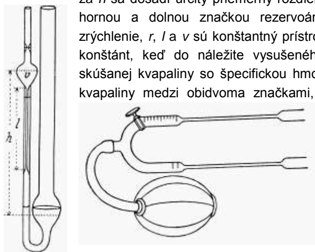
Obr. Vľavo: Hessov viskozimeter, vpravo: Ostwaldov viskozimeter
